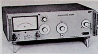
De normale versie heeft een gevoeligheid van -95dB (meter op 0 dB), het type E.V.B. 50 P gaat tot -115 dB. De eigenruis van de
